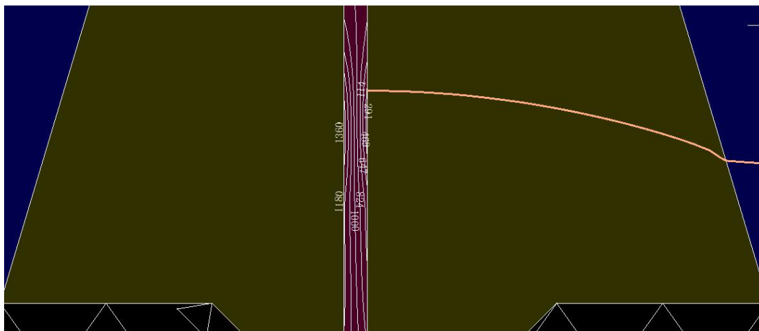
防渗墙底部竖向应力等值线(KPa)，未出现拉应力
